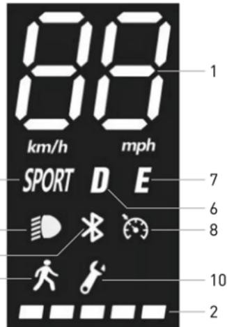
1. Brzinomjer: Prikazuje trenutnu brzinu romobilja.
